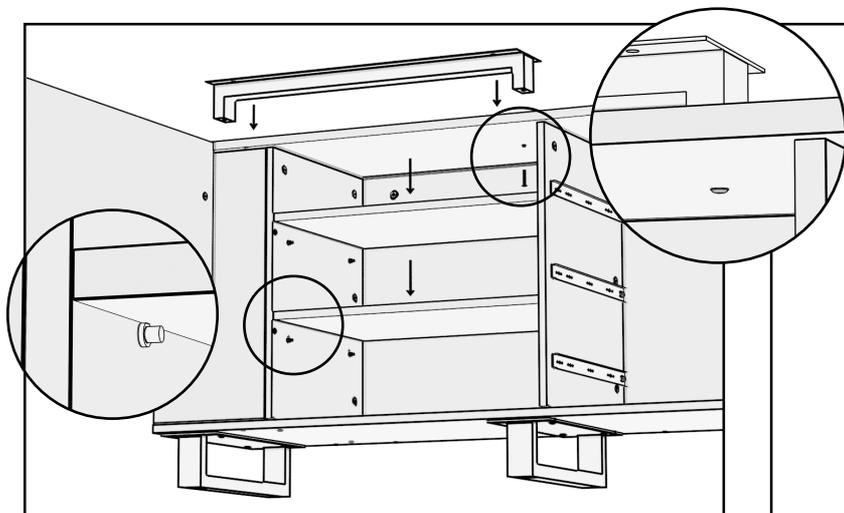
Вставьте полкодержатели в заднюю стенку ниши и в перегородку. Положите на них полки. То же самое проделайте с передней нишей. С помощью винтов М6х30 прикрутите малую опору к крышке тумбы.
