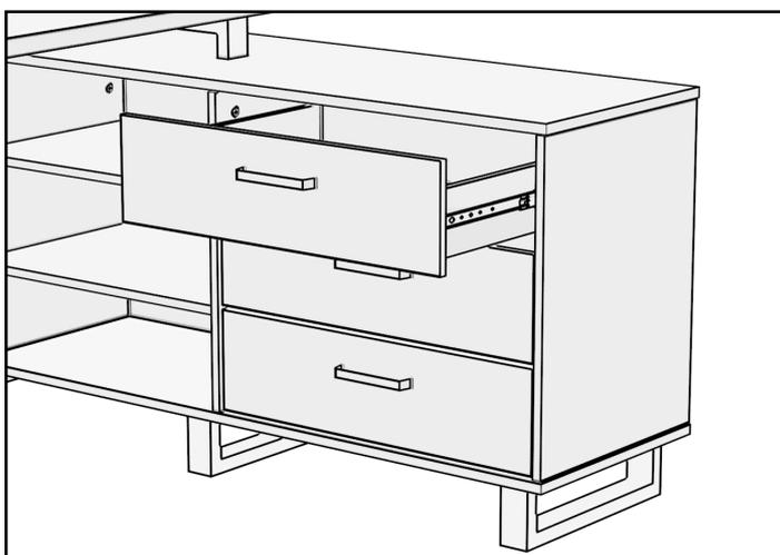
Установите собранный ящик соединив части телескопических направляющих. Для этого надо выдвинуть промежуточную рельсу, сопоставить внутренние направляющие на ящике с выдвинутыми частями наружных направляющих на корпусе, и аккуратно задвинуть ящик до характерного щелчка.
