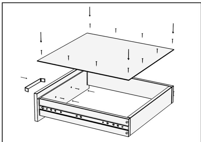
Прикрутите к фасаду ящика ручку с помощью винтов М4х22. Вставьте дно ящика в паз на фасаде и прибейте с помощью гвоздей.
