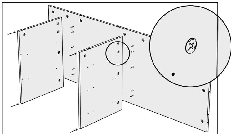
Вкрутите штоки минификсов, вставьте шканты и эксцентрики в заднюю стенку тумбы. Вставьте эксцентрики в перегородку и заднюю стенку ниши. Соедините их с задней стенкой тумбы с помощью минификсов. Затяните минификсы.
