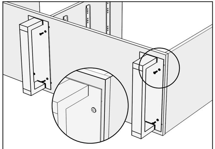
Прикрутите опоры к тумбе с помощью винтов М6х12.
