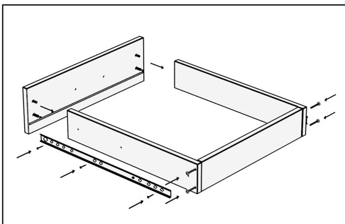
Соедините боковые стенки ящика с задней стенкой с помощью конфирматов. В фасад ящика вкрутите штоки минификсов и вставьте шканты. Соедините фасад с боковыми стенками ящика и затяните минификсы. Внутренние части направляющих прикрутите к боковым стенкам саморезами.
