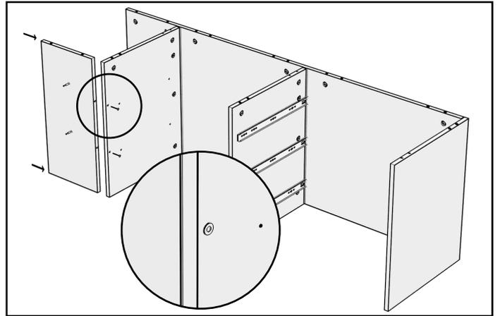
Вкрутите штоки минификсов и вставьте эксцентрики минификсов в боковину передней ниши. С помощью конфирматов соедините её с задней стенкой ниши.
