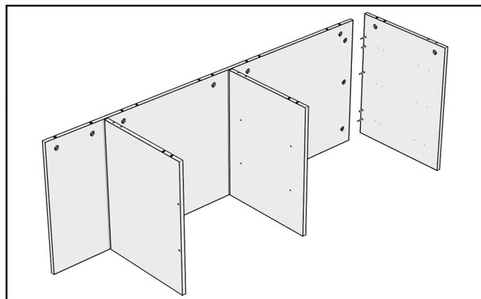
Вкрутите штоки минификсов, вставьте шканты и эксцентрики в правую стенку тумбы. Соедините ее с задней стенкой тумбы. Затяните минификсы.
