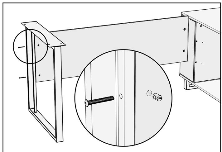
Вставьте эксцентрики минификсов и бонку М6 в царгу. Соедините с помощью минификсов царгу с столом. Боковую опору соедините с царгой с помощью винтов М6х50.
