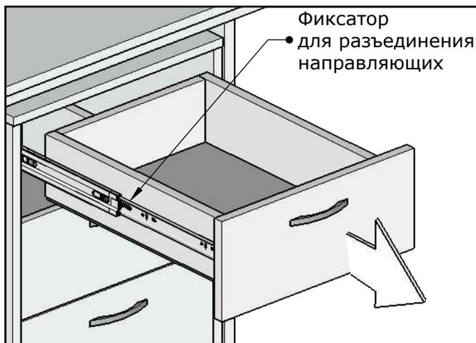
Выдвигаем ящик что бы проверить зафиксирован ли он
