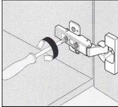
регулировка по глубине
