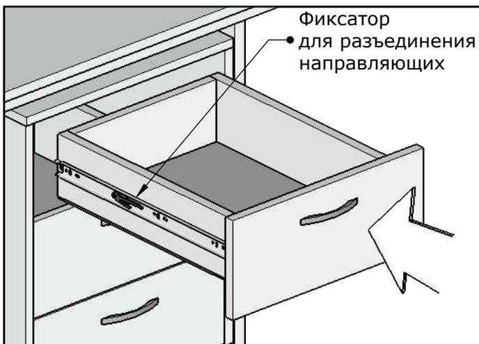
Устанавливаем ящики на направляющие до характерного щелчка.
