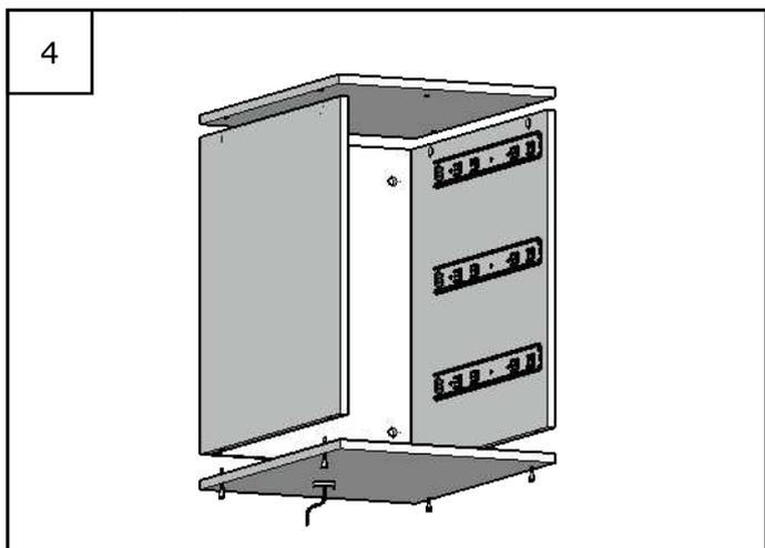
Затем крепим конфирматами дно к стоевым тумбы. И крышку прикручиваем с помощью минификсов.
