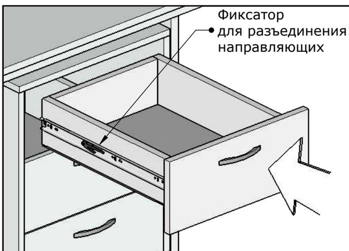
Устанавливаем ящики на направляющие до характерного щелчка.
