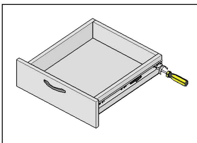
Прикручиваем внутреннюю часть направляющих к боковым деталям ящика саморезами
