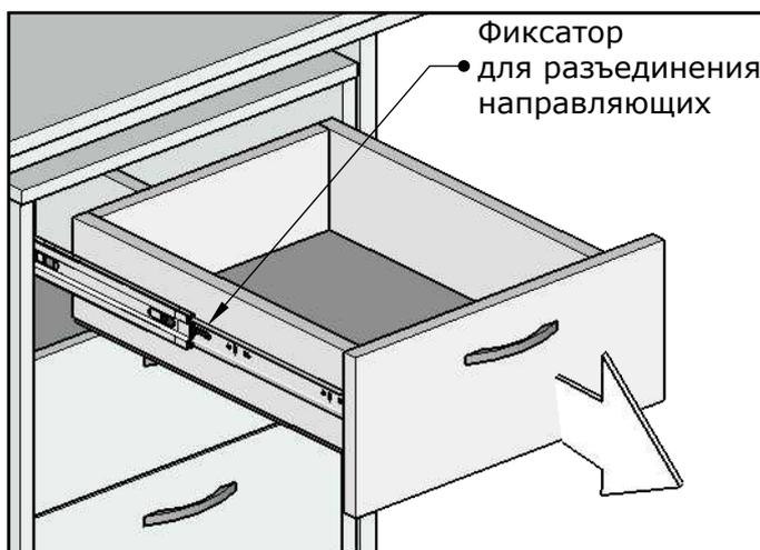
Выдвигаем ящик что бы проверить зафиксирован ли он
