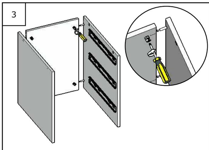
Вставляем эксцентрики минификса в заднюю стенку тумбы, а штоки в боковины тумбы. Скрепляем между собой.
