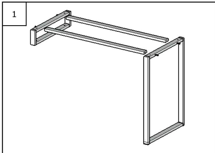
Соединяем опоры стола с перемычками с помощью винтов М6\*50.
