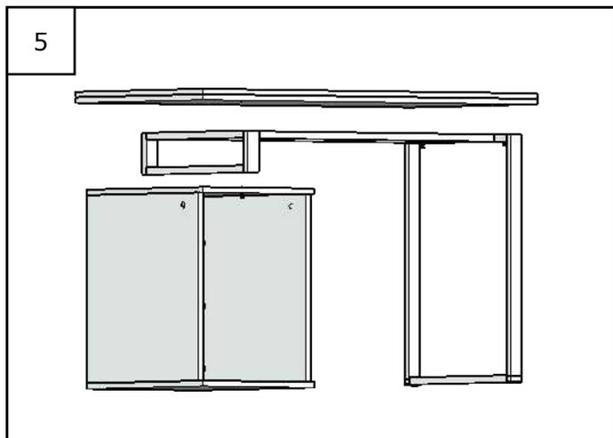
Винтами 6x30 крепим металлический каркас к тумбе. Устанавливаем столешницу и на каркас и крепим её с помощью винтов М6\*30.
