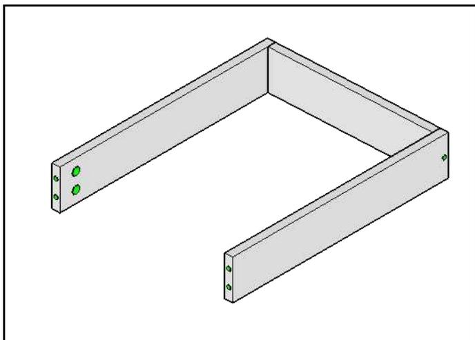
Детали ящика соединяем между собой с помощью конфирматов.
