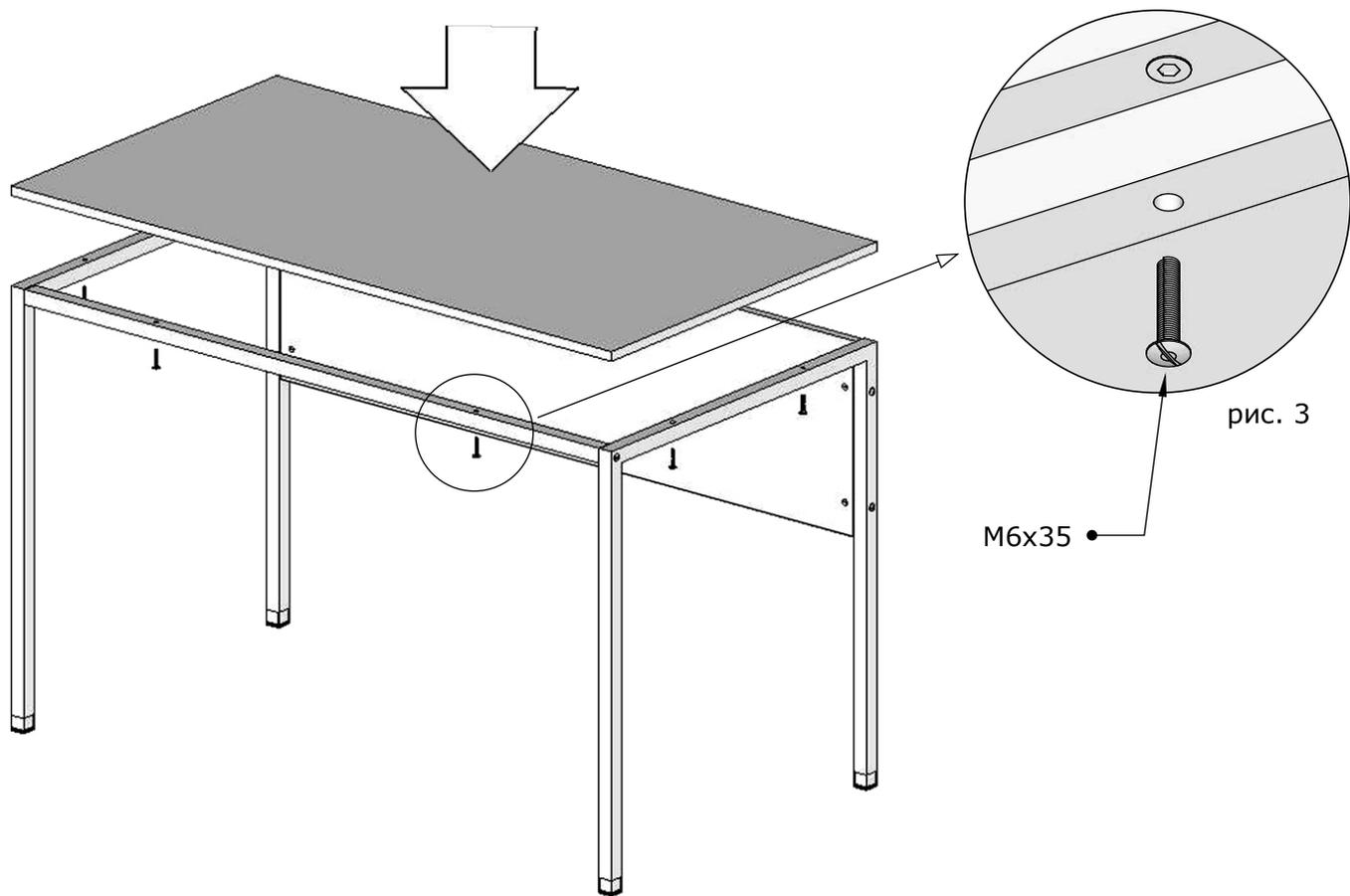
Крепим столешницу винтами M6x35. **Затягиваем все винты до упора, но без большого усилия.**
