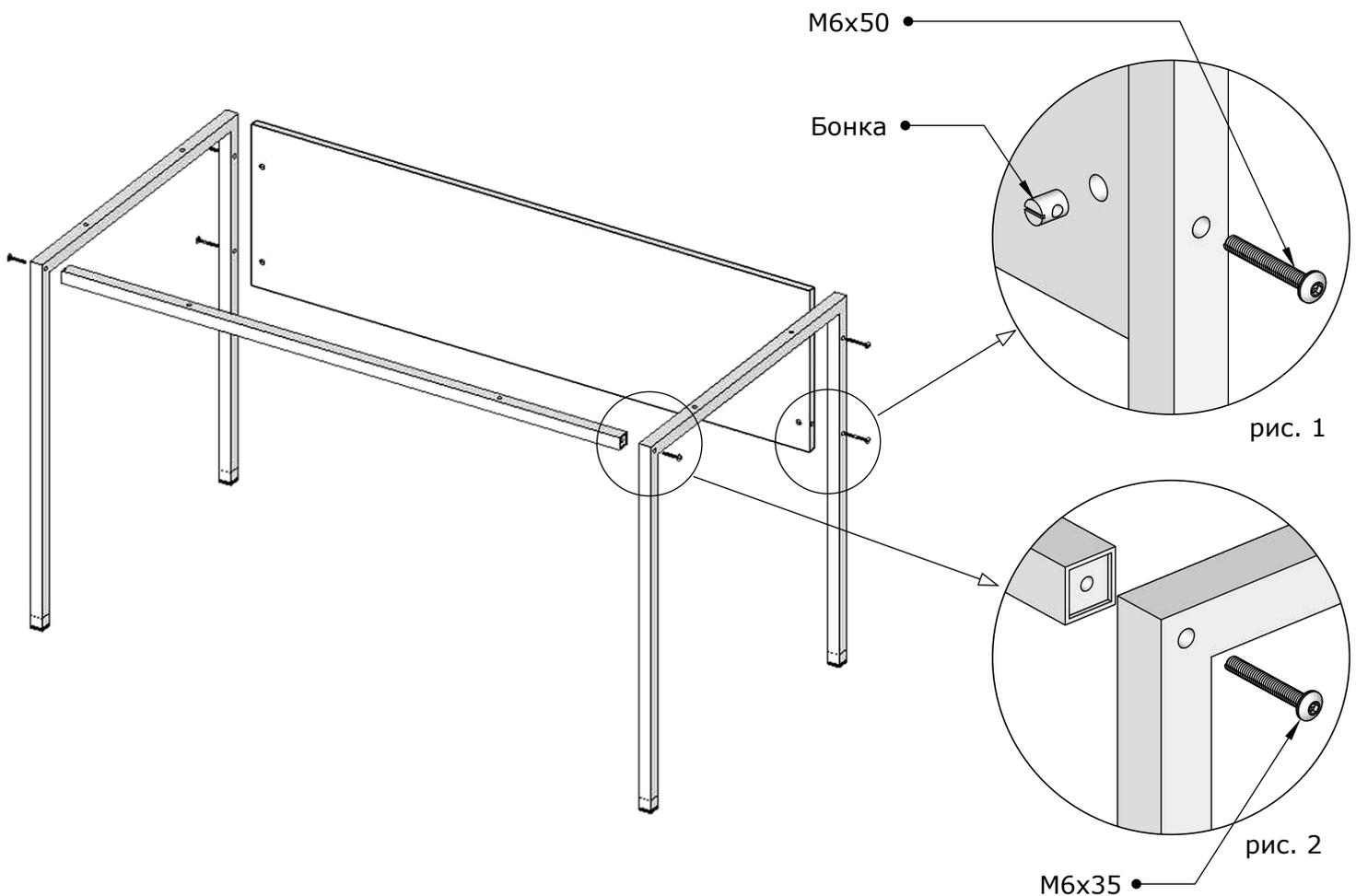
В глухие отверстия царги вставляем бонку. Крепим царгу винтами М6х50 между металлических опор, так чтобы винт вошел в бонку (рис. 1). **Винты до конца не затягиваем!**
