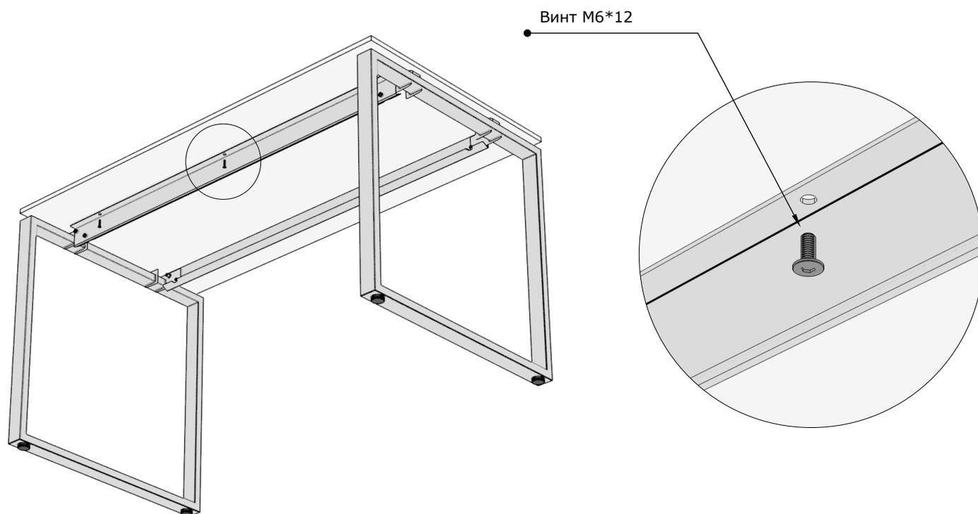
Положите столешницу на каркас. Наживите винты М6\*12 во все шесть отверстий. Когда все винты будут насажены в отверстия и выравнены диагонали затяните винты до упора.
