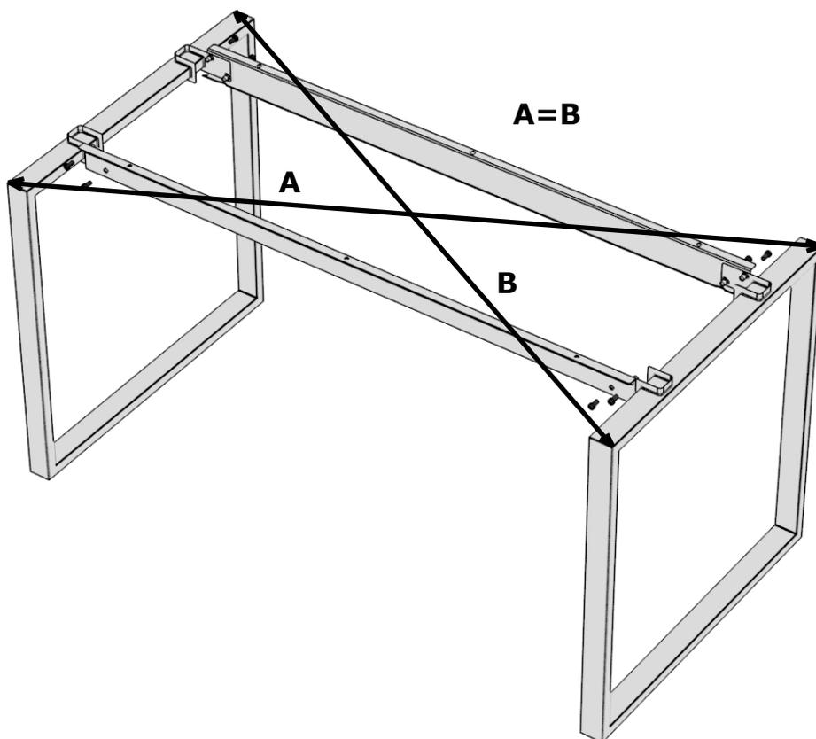
Замерьте диагонали каркаса, как указано на рисунке. Они должны быть равны.
